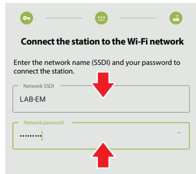
11. Enfin, si vous voulez connecter l'appareil à un réseau wifi externe, entrez le nom du réseau (SSID) et son mot de passe pour connecter l'appareil. Appuyer sur la touche CONFERMA (confirmer) ou Salta la procedura (Sauter la procédure) pour compléter l'activation de l'appareil.
